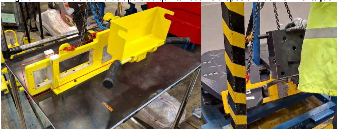
Figura 12 – Novo sistema de apoio da quinta roda no dispositivo de movimentação.
