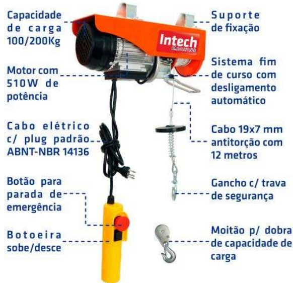
Figura 4 – Componentes da talha elétrica.
