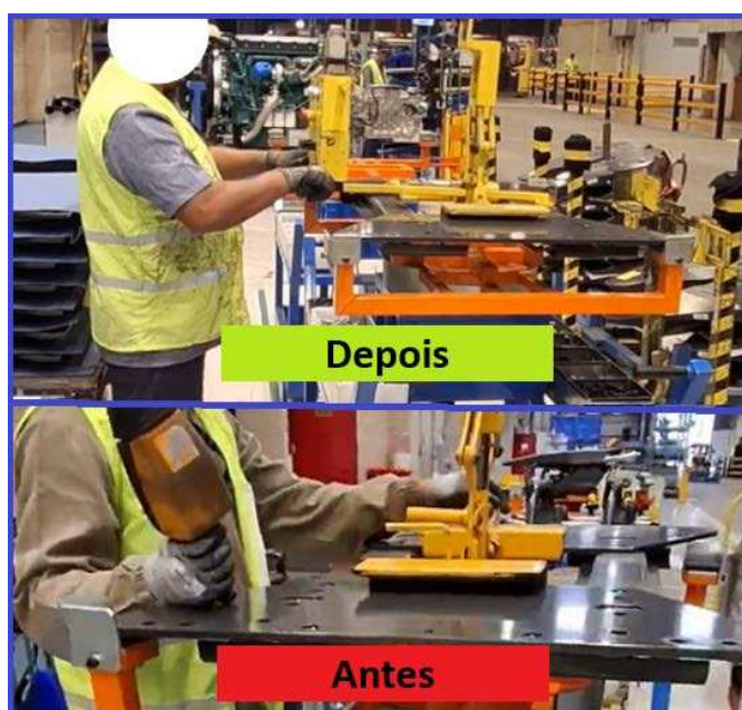
Figura 14 – Antes e depois do posicionamento da sela no carrinho
