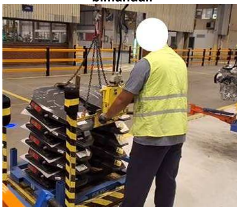
Figura 13 – Operador utilizando o dispositivo de movimentação equipado com o painel bimanual.
