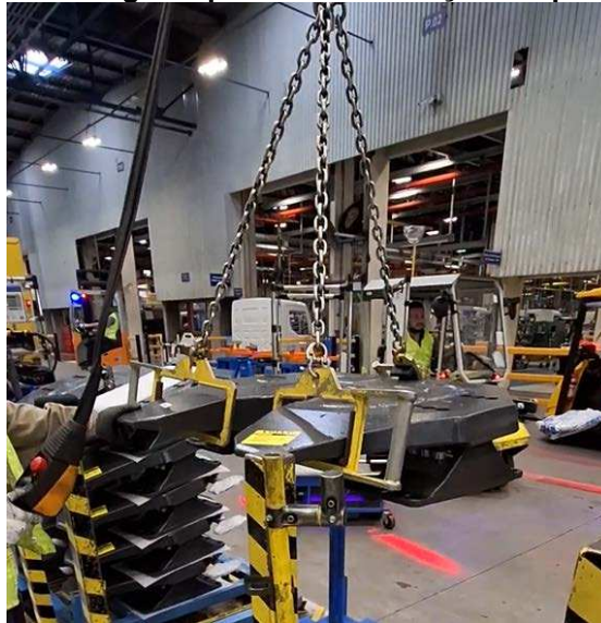
Figura 6 – Antigo dispositivo de elevação da quinta roda.
