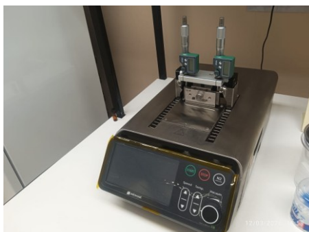
Figura 29 – Blade Coater BCC-02, lâmina do tipo LC01 e mecanismo de ajuste de altura
