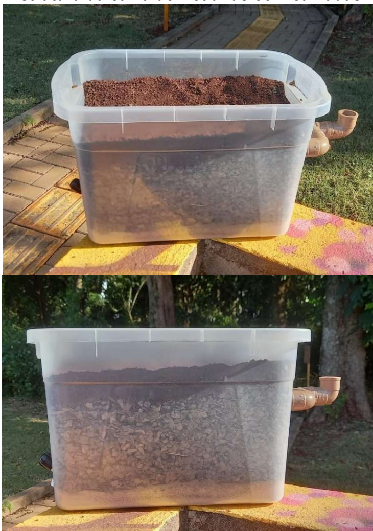
Fotografia 10 - Estrutura da caixa de wetlands com camadas representativas
