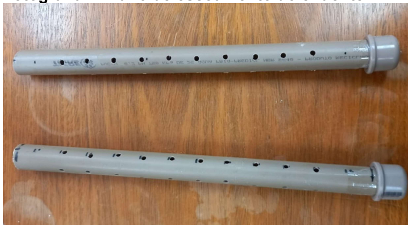
Fotografia 2- Cano de escoamento do efluente
