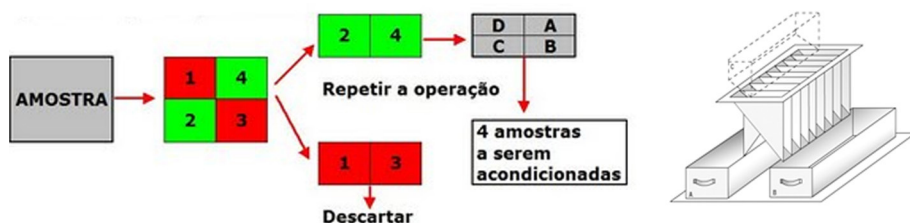
Figura 24 – Amostra quarteada manualmente e quarteador de Jones Fonte: Na sala com Gismonti (2009).
