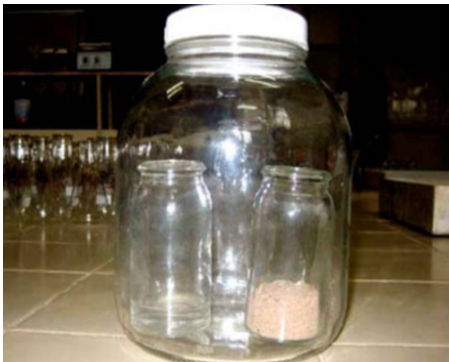
Figura 30 – Frascos utilizados para a incubação, juntamente com a amostra de solo e seu respectivo frasco contendo NaOH
