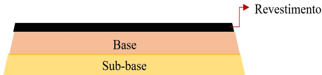
Figura 9 – Perfil esquemático do pavimento do trecho estudado
