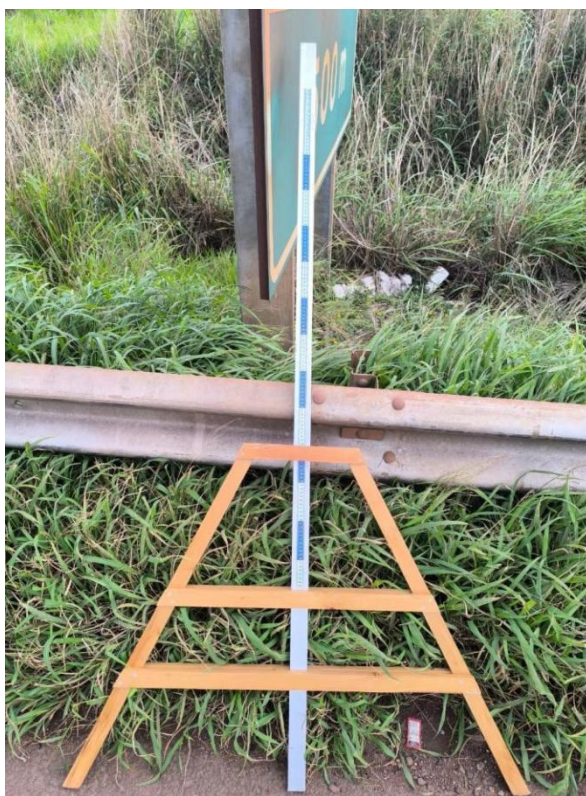
Figura 15 – Cavalete de madeira para medição das flechas de trilha de roda
