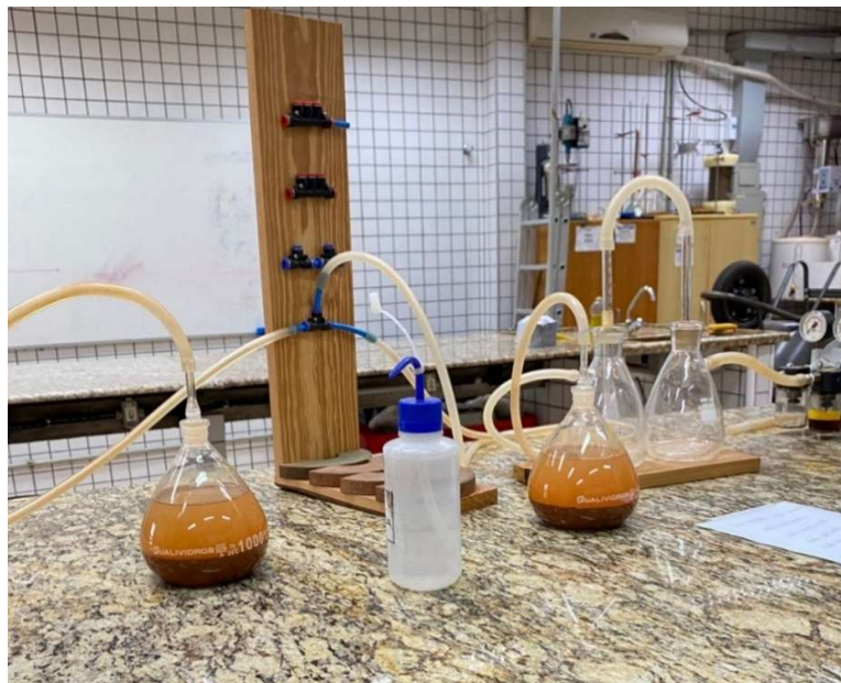
Figura 13 - Amostras no processo aplicação de vácuo
