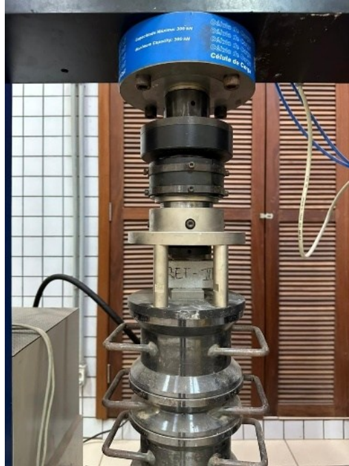
Figura 10 – Corpo de prova na prensa hidráulica para o ensaio de compressão
