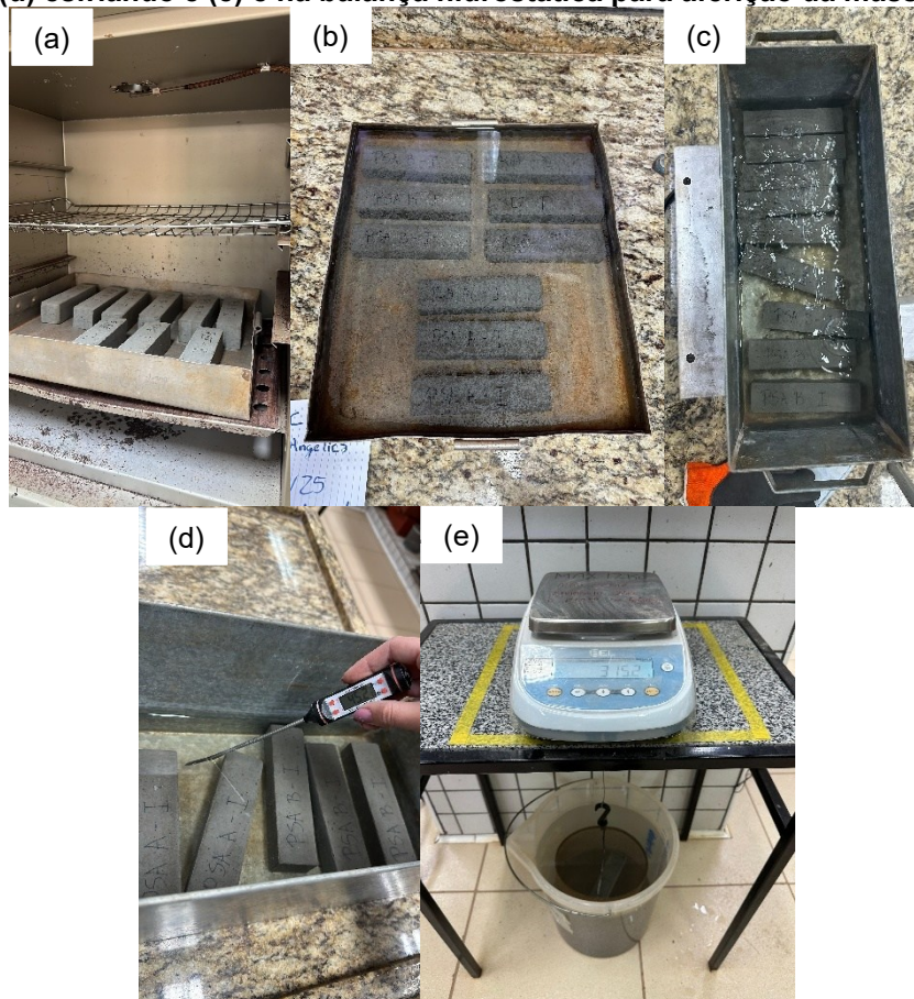
Figura 8 – Corpos de prova: (a) na estufa para secagem, (b) imersos em água, (c) em fervura, (d) esfriando e (e) e na balança hidrostática para aferição da massa
