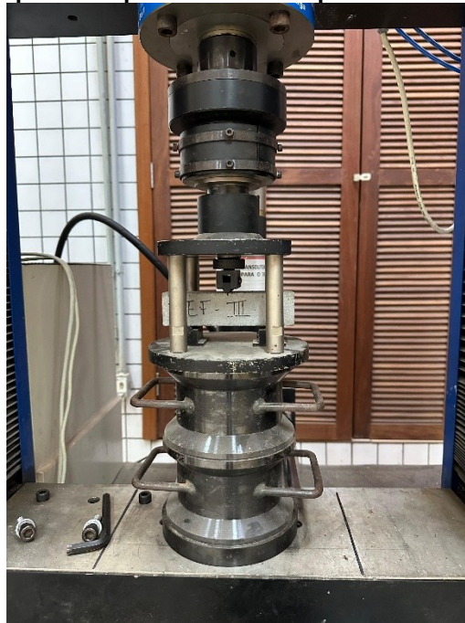
Figura 9 – Corpo de prova na prensa hidráulica para o ensaio de tração na flexão
