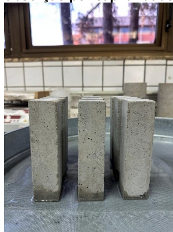
Figura 7 – Ensaio de absorção por capilaridade em desenvolvimento
