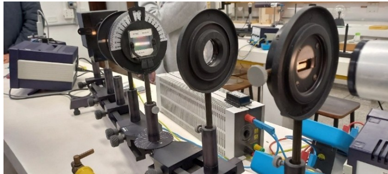
Figura 16 - Processo de seleção de comprimento de onda com espectrômetro e rede de difração
