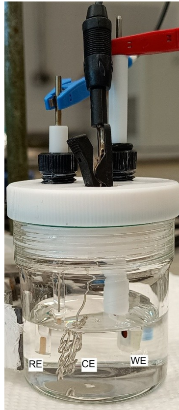
Figura 8 - Cella eletroquímica utilizada nas medidas. CE – contra eletrodo; RE – eletrodo de referência e WE – eletrodo de trabalho.
