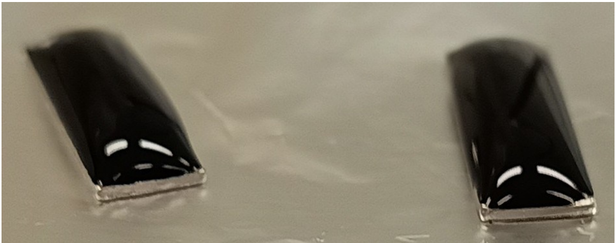
Figura 10 – Eletrodos de Pt sobre chapa de aquecimento com as soluções de PANI em NMP recém depositadas.
