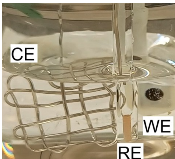
Figura 9 – Ampliação dos eletrodos em solução. CE – contra eletrodo; RE – eletrodo de referência e WE – eletrodo de trabalho
