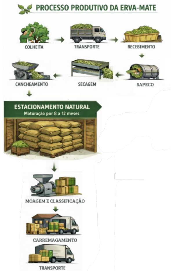
Figura 1 - Fluxograma do processo produtivo da erva-mate com estacionamento natural
