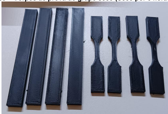
Figura 39 – Corpos de prova do grupo seco (Seco por 5 horas a 50°C)
