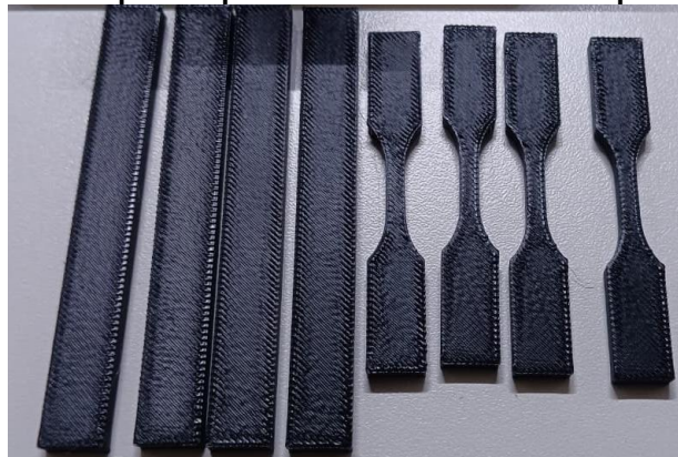
Figura 37 – Corpos de prova com filamento úmido por 48 horas
