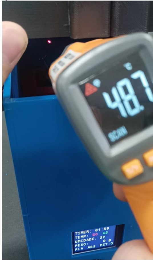
Figura 28 – Medição do termômetro infravermelho a laser SOLDEN TD-580
