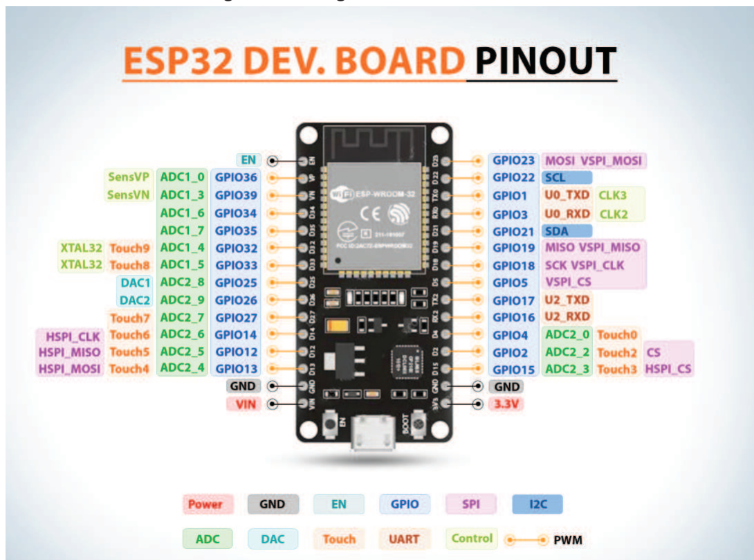
Figura 9 – Pinagem do ESP32 Dev Board
