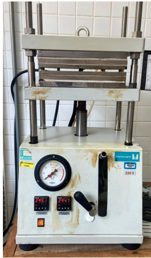
Figura 8 - Prensa aquecida disponível no LAB 001 UTFPR/LD.
