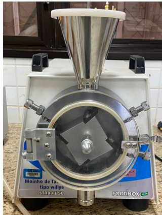
Figura 6 - Moinho de facas star ft 50 disponível no LAB 002 UTFPR/LD.
