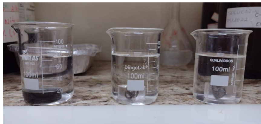
Figura 15 – Amostras de FeNb submersas em HCl 1M
