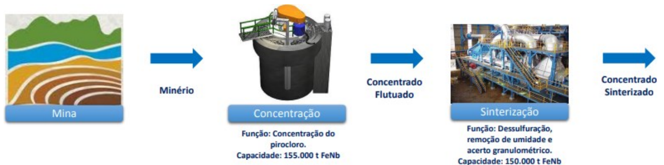
Figura 6 - Processo de extração, concentração e sinterização da liga FeNb
