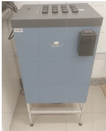
Figura 19 – Equipamento de calor de hidratação
