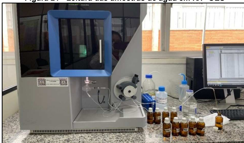
Figura 21 - Leitura das amostras de água em ICP-OES
