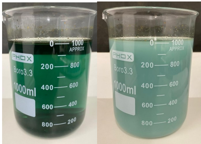
Figura 17 - Solução com Corante VB (Verde de Bromocresol) Antes da Degradação: a) Sem Fotocatalisador b) Com Fotocatalisador \text{TiO}_2
