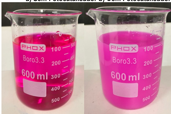
Figura 18 - Solução com Corante RB (Rodamina B) Antes da Degradação: a) Sem Fotocatalisador b) Com Fotocatalisador \text{TiO}_2
