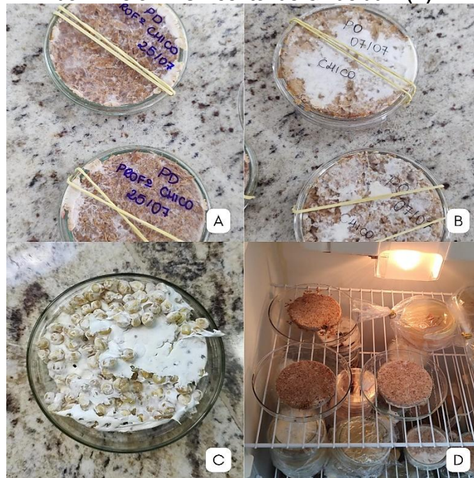
Figura 10 – Compósitos de P. djamor e P. ostreatus , respectivamente, em bagaço triturado (A e B); Compósitos de G. lucidum em grãos de milho (C); Compósitos de bagaço de cana e palha de milho em BOD contendo G. lucidum (D)
