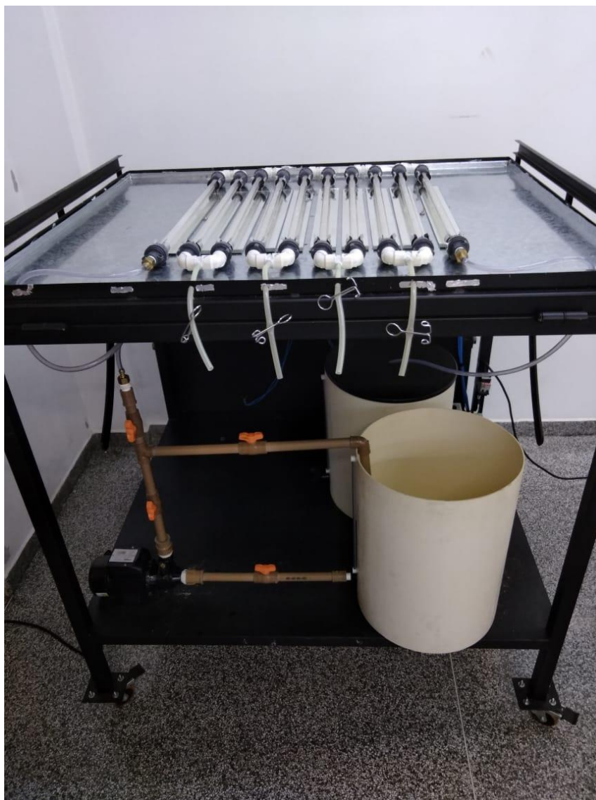
Figura 9 - Protótipo utilizado para reações fotolíticas e fotocatalíticas em fluxo contínuo.
