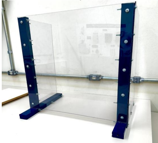
Figura 19 – Base com proteção nos terminais
