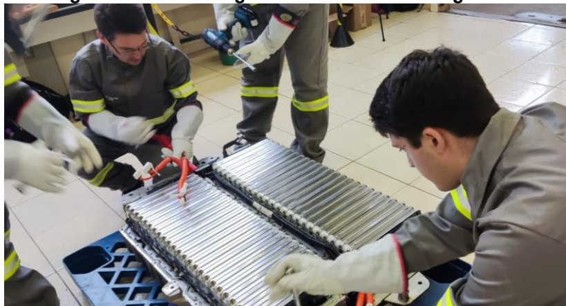
Figura 6 – Desmontagem Bateria Renault Kangoo Z.E.
