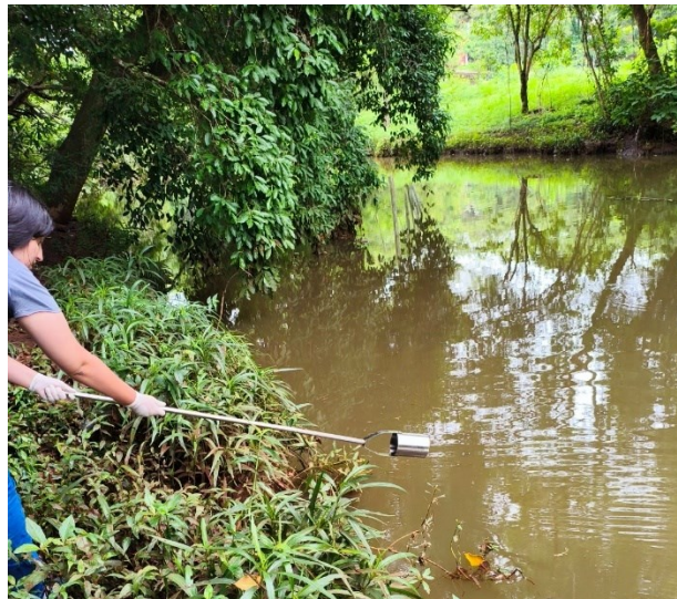
Figura 8 – Coleta das amostras de água utilizando o equipamento do coletor de braço retrátil
