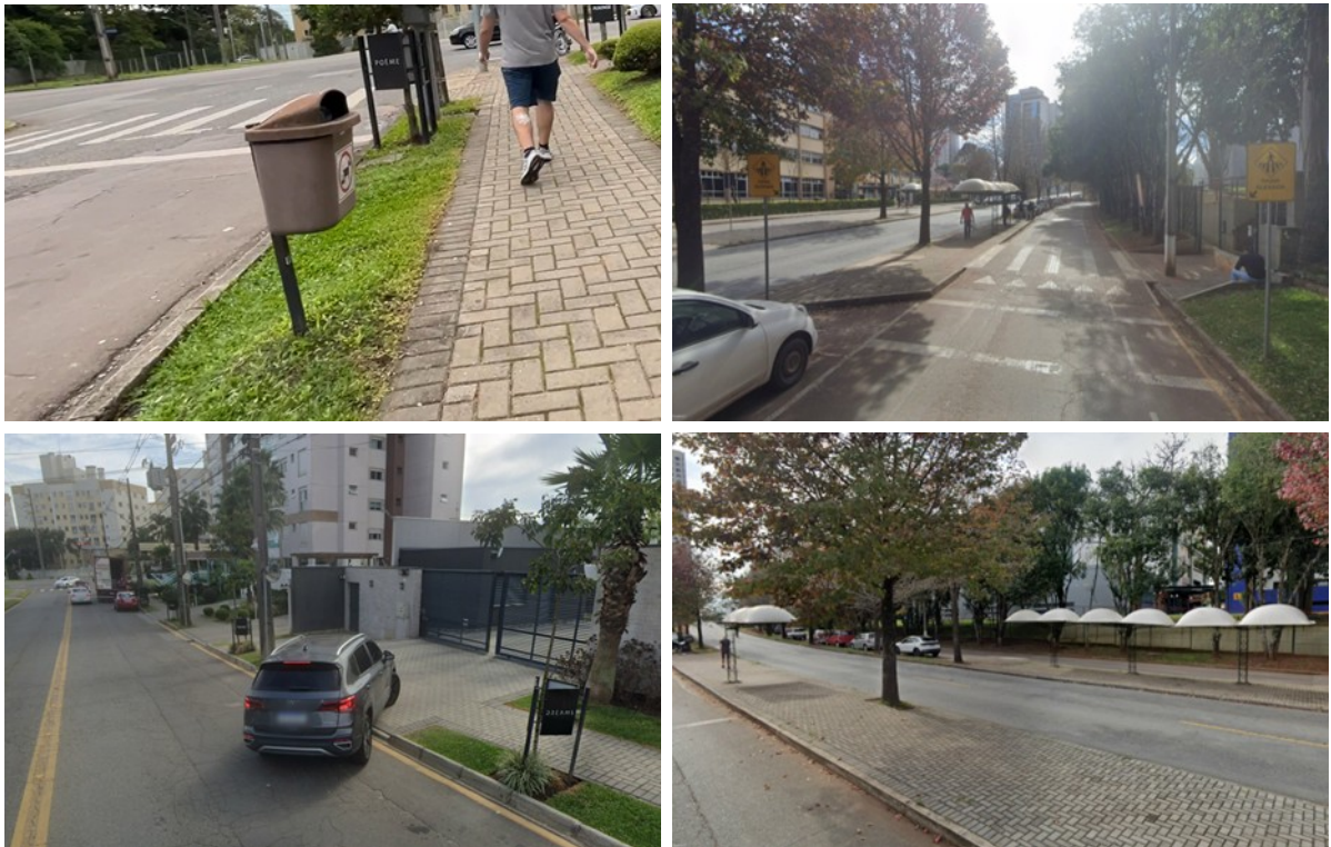
Figura 30 – Lixeira pública (superior, à esquerda), faixa de pedestres elevada com ampliação da calçada (superior, à direita), guia rebaixada para veículos (inferior, à esquerda) e pontos de ônibus (inferior, à direita)
