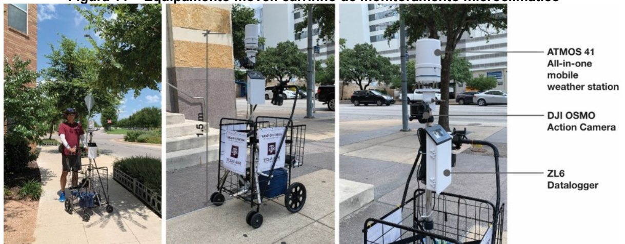
Figura 11 – Equipamento móvel: carrinho de monitoramento microclimático
