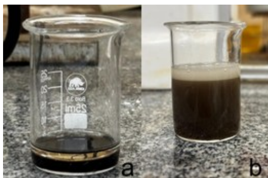
Figura 10 - Testes da homogeneidade a) somente AP + OE; b) mistura OE, AP, água e TW20.
