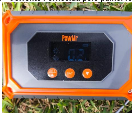
Figura 38 - Corrente Fornecida pelo painel fotovoltaico
