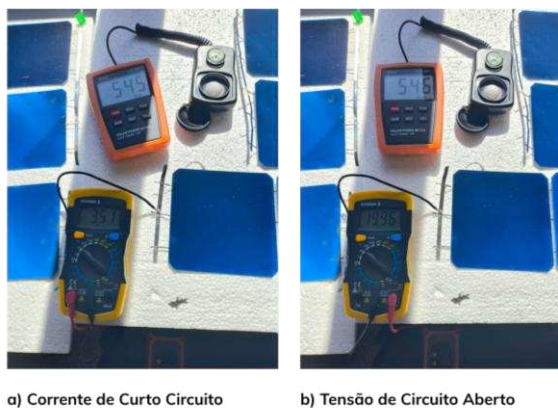
Figura 31 - Medições de irradiância solar, corrente e tensão durante a simulação em ambiente fechado
