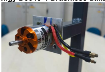
Figura 3 - Motor Turnigy D3548-4 Brushless utilizado nas simulações
