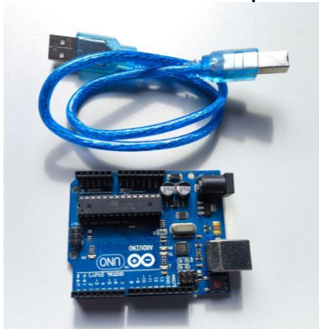
Figura 8 – Microcontrolador Arduino UNO utilizado para simular os estágios de voo
