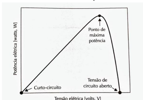
Figura 26 - A curva característica potência-tensão (P-V)
