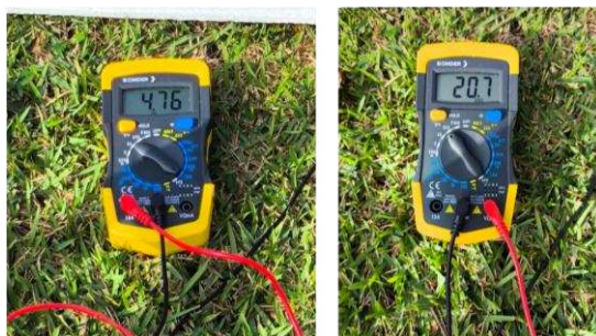
Figura 39 - Medições de Corrente e tensão do painel
