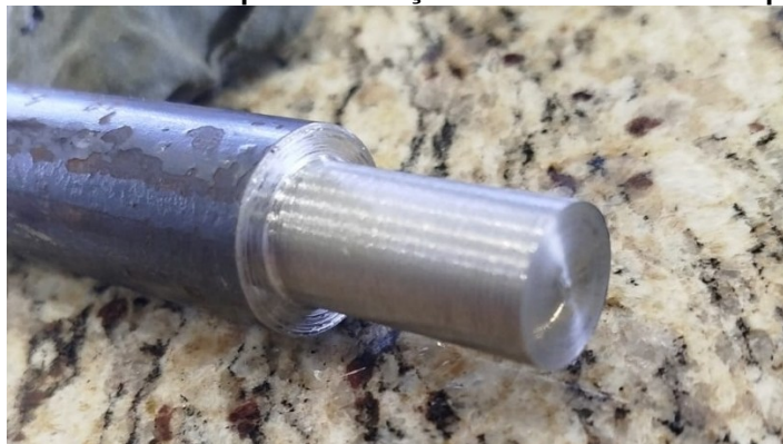
Figura 38: Material base para fabricação do eixo e outros componentes.
