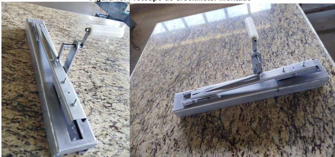
Figura 46: Protótipo do crockmeter montado
