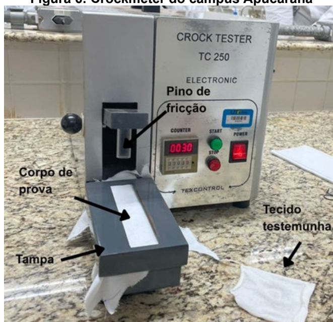
Figura 6: Crockmeter do campus Apucarana
