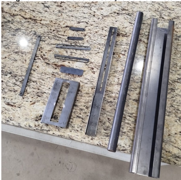
Figura 44: Materiais de construção do crockmeter
