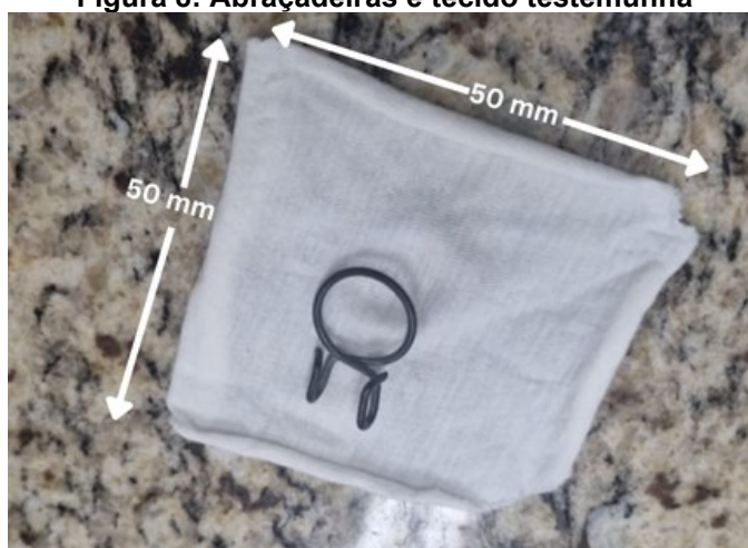
Figura 8: Abraçadeiras e tecido testemunha
