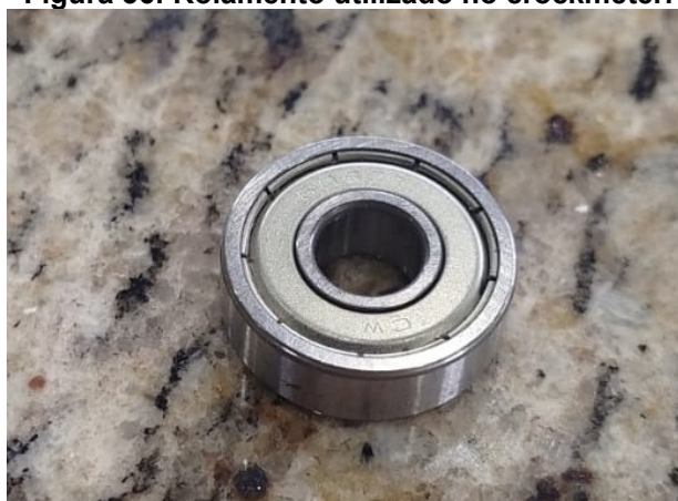
Figura 36: Rolamento utilizado no crockmeter.
