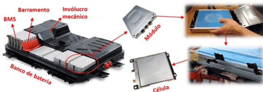
Figura 7 – Banco de Bateria de Veículo Elétrico
