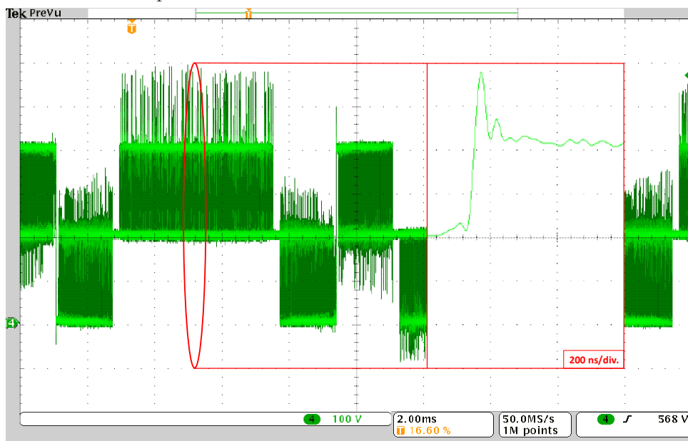
Figura 98 – Tensão de bloqueio nas comutações. Tensão entre dreno e fonte do MOSFET S_1 .
