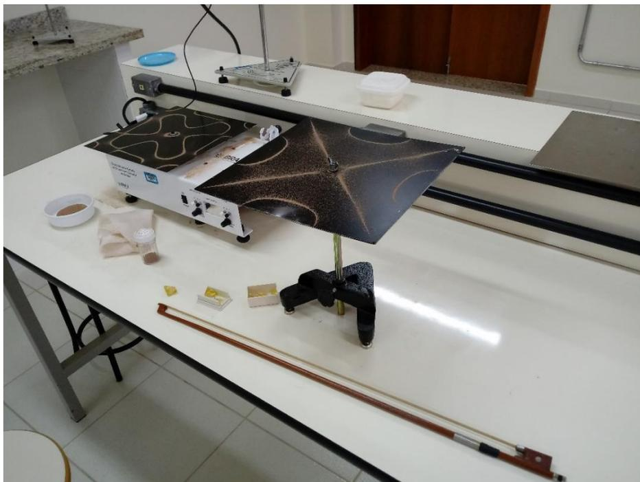
**Fotografia 3 – Modelo Original do experimento de Chladni e Modelo adaptado ao gerador de frequências**
