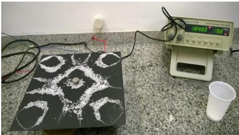
**Fotografia 6 - Figura gerada com o uso do gerador de sinais.
