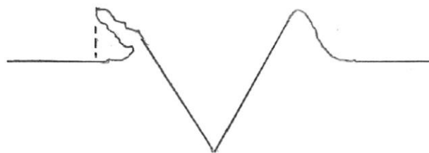
Figura 2.11 – Perfil de risco com a formação de “ chips ”. Fonte: FRANCO; SINATORA, 2016.
