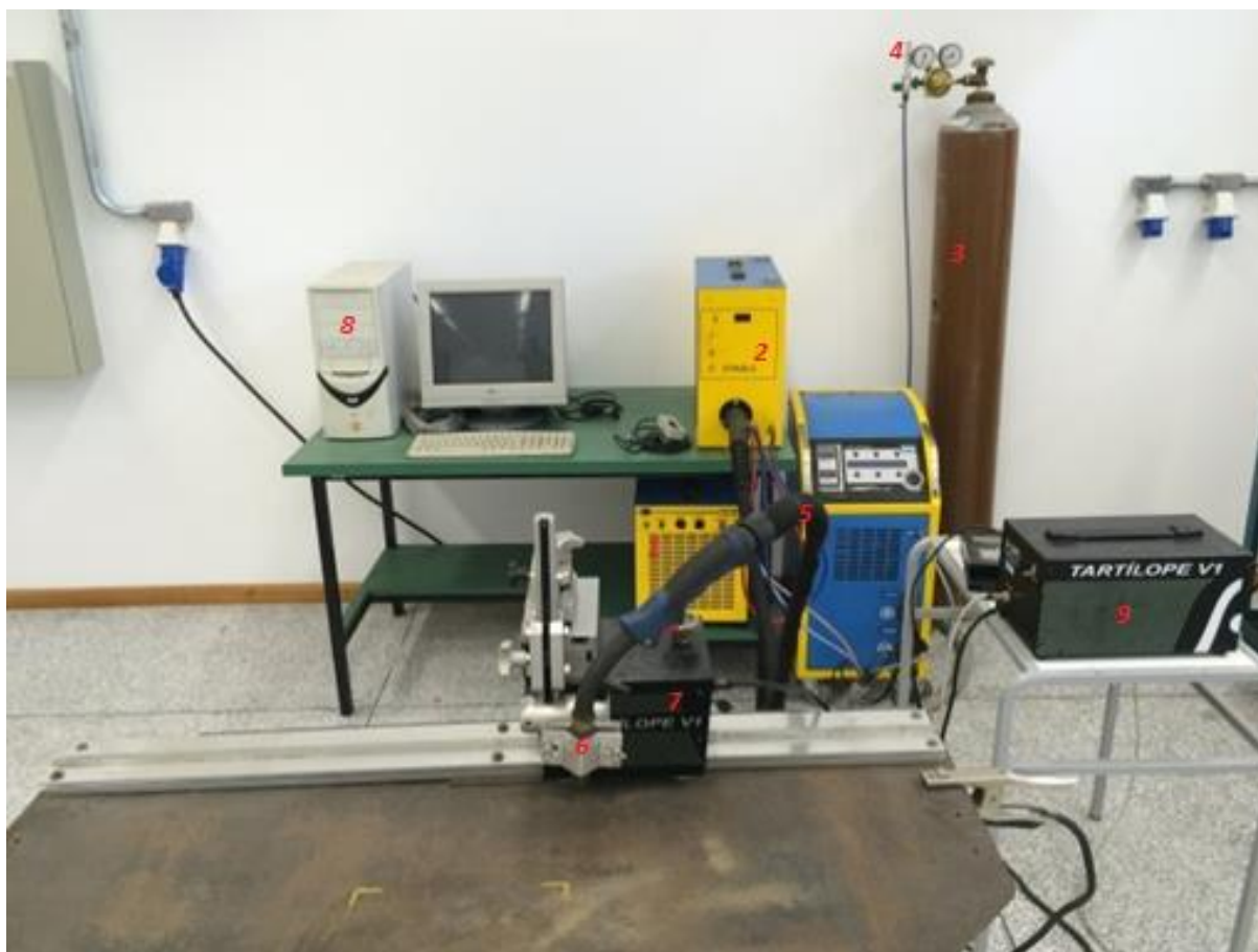
Figura 3.1 - Bancada de deposição dos cordões de solda. Fonte: Autor.
