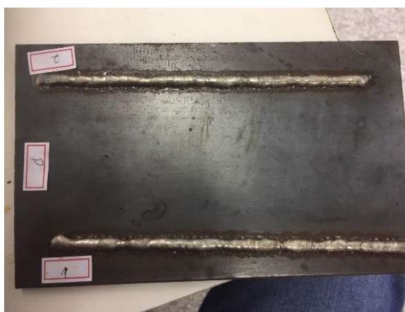
Figura 3.4 - Exemplo de chapa com os cordões depositados: Corrente Pulsada. Fonte: Autor.
