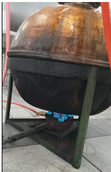
Figura 4 - Aquecimento do mosto, aplicando-se chama direta sob o alambique
