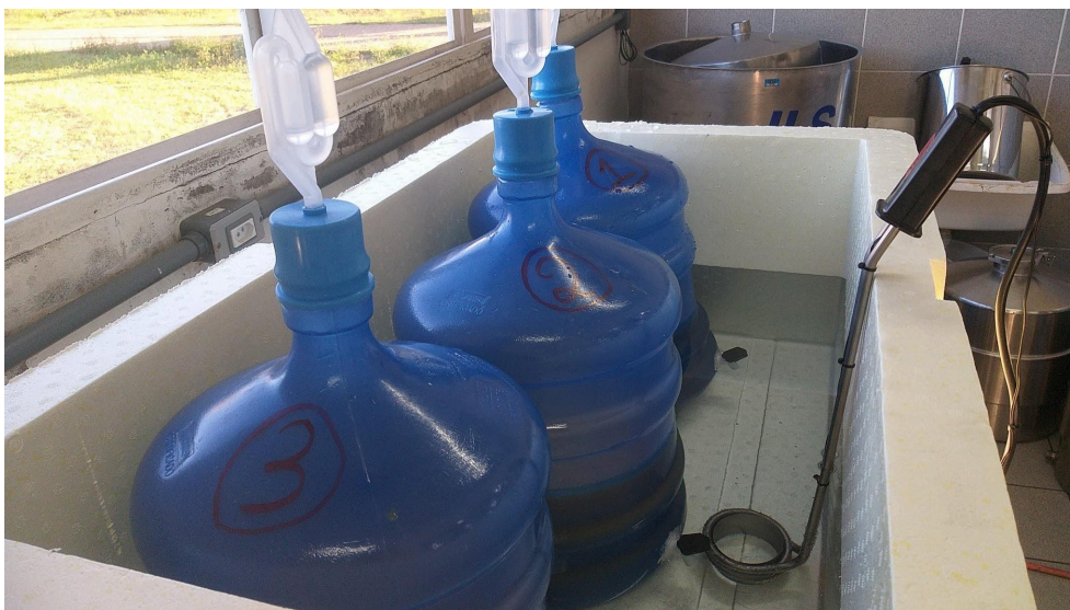
Figura 3 - Sistema De Controle De Temperatura
