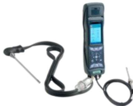
Figura 7 – Analisador de gases Ecil Chemisti 500.
