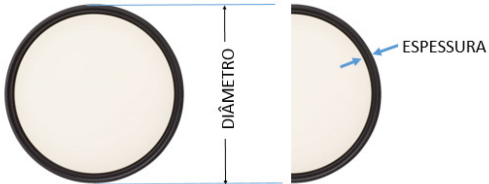
Figura 46 – Parâmetros de diâmetro e espessura do aro do volante – Sprint 2
