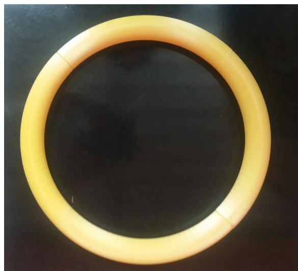
Figura 47 – Aro do volante impresso em 3D – Sprint 2
