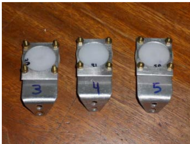
Figura 18 - Discos de PEAD com espessuras de 3, 4 e 5 mm. A imagem mostra os discos prontos para serem acoplados na estrutura da câmara de espalhamento no IEN.
