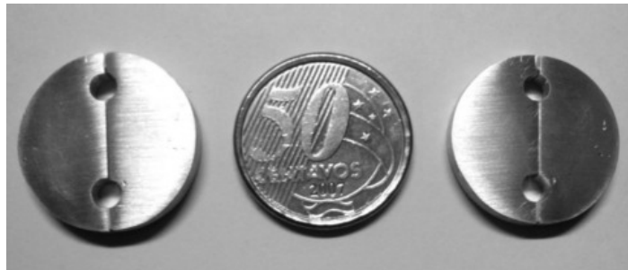
Figura 38 - Colimadores construídos, à esquerda 0,1 mm e à direita 0,2 mm
