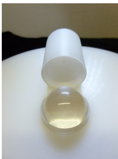
Figura 62 – A esfera e um dos suportes usinados para compor o núcleo do phantom em PEAD.
