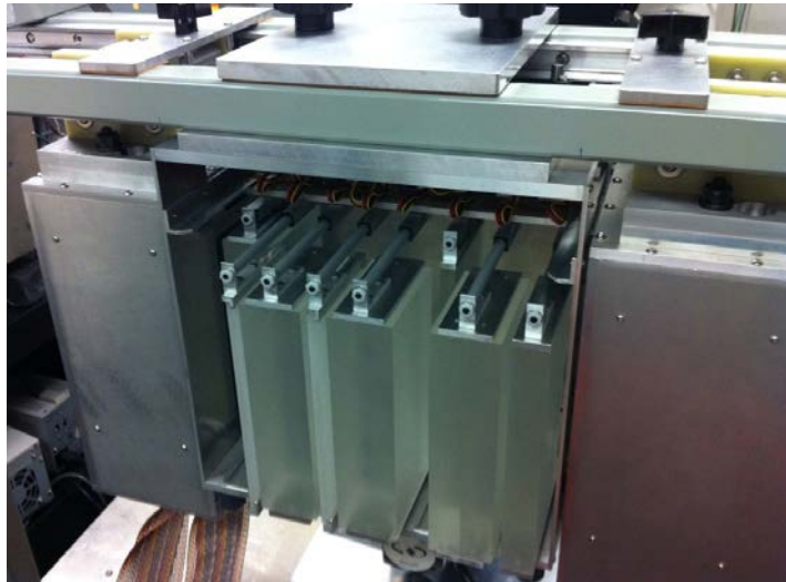
Figura 12 – Blocos de Poliestireno utilizado para calibrar o calorímetro
