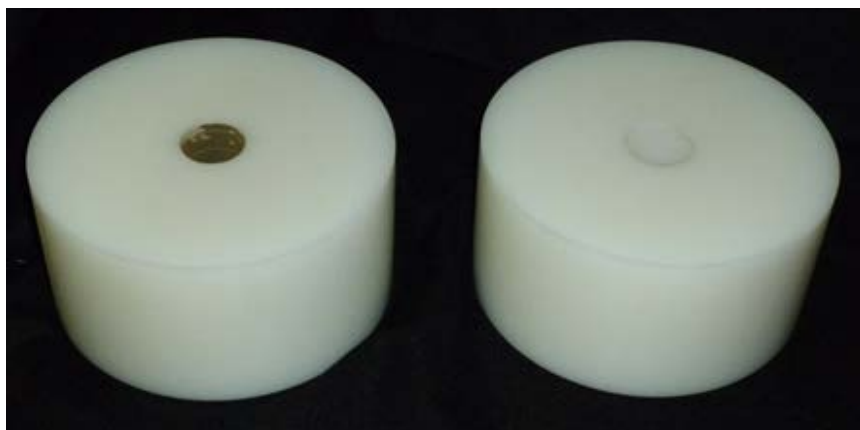
Figura 61 - Phantoms de PEAD à esquerda com núcleo cilíndrico e à direita com núcleo em esfera.
