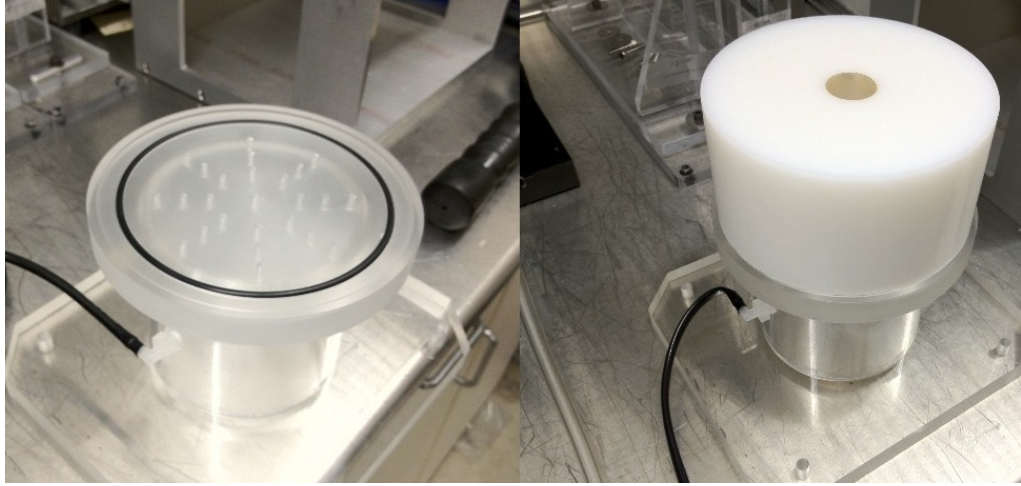
Figura 65 – Suporte a vácuo utilizado no protótipo do LLUMC.
