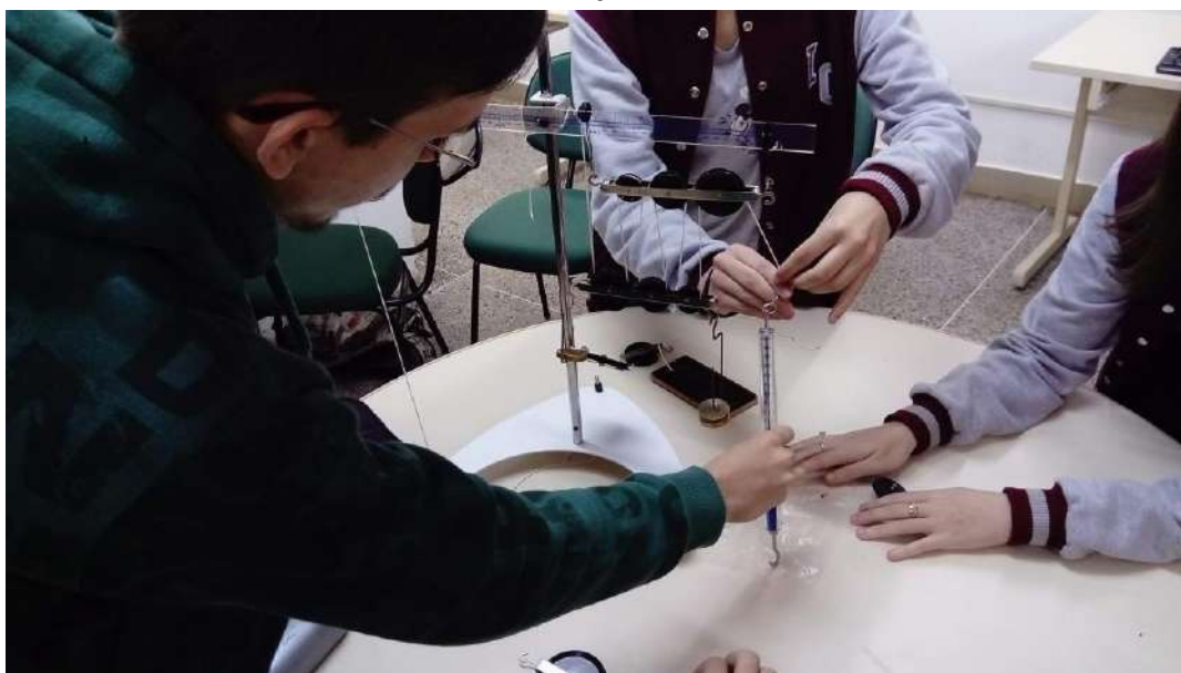
Figura 10 – Um grupo de estudantes do curso de Edificações mede a força ativa da máquina simples
