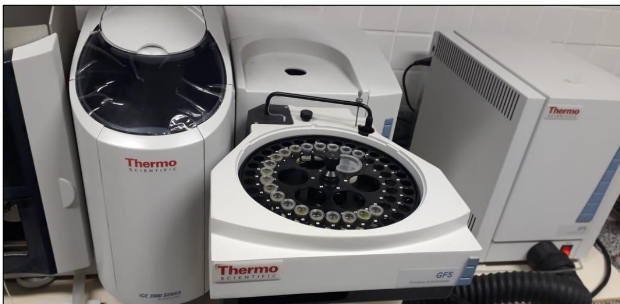
Figura 35: Espectrômetro de Absorção Atômica com Atomização em Forno de Grafite (GF AAS) da marca Thermo Scientific, modelo ICE 3000
