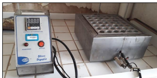
Figura 34: Bloco digestor SOLAB
