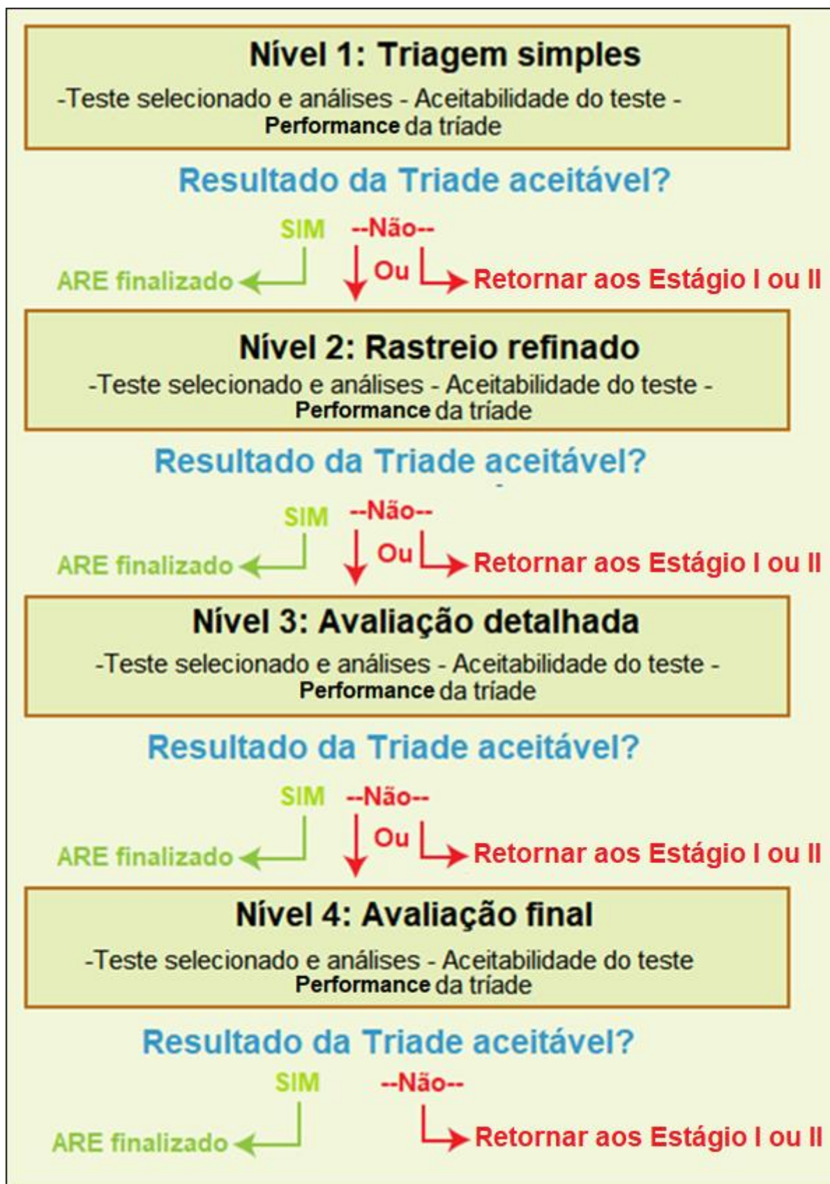
Figura 3: Fluxograma da ARE seguindo os níveis de aperfeiçoamento do método. O Estágio III da ARE proposta pelos autores possui 4 níveis de aprofundamento das análises a depender do resultado anterior ser aceitável ou não.
