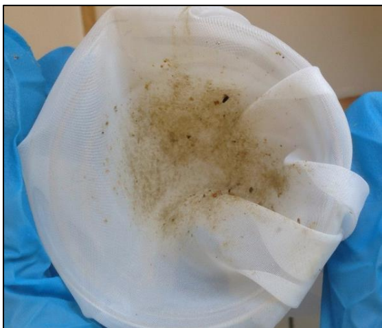
Figura 31: Processo de passagem da amostra seca através malha para a obtenção de mesma granulometria
