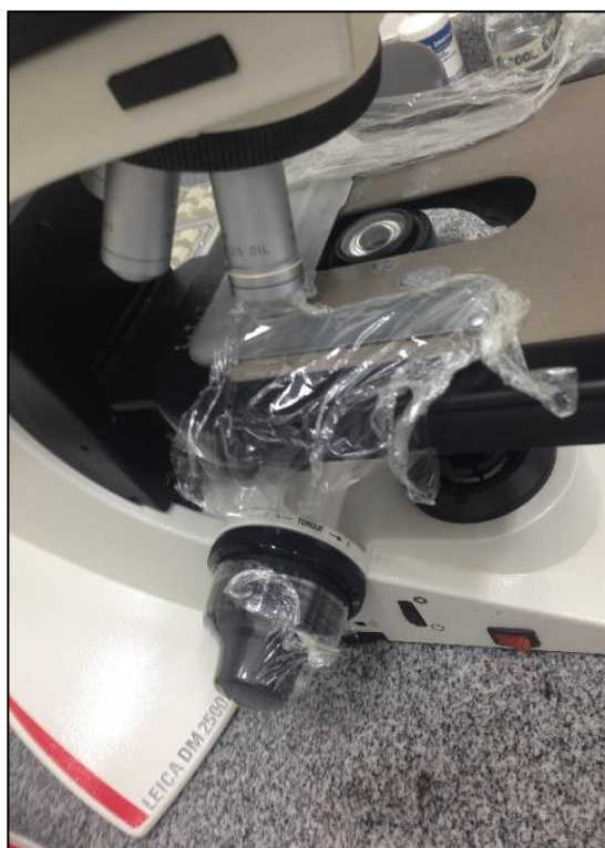
Figura 40: Exemplo de proteção para evitar contaminação do corante tóxico
