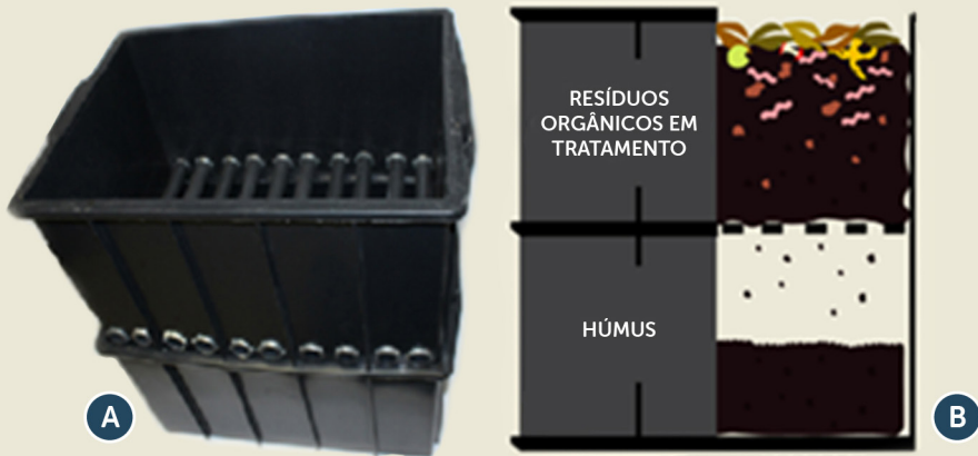
Figura 16 – Modelos de vermidigestores com barras, A: foto de caixa adaptada, B: Esquema de funcionamento
