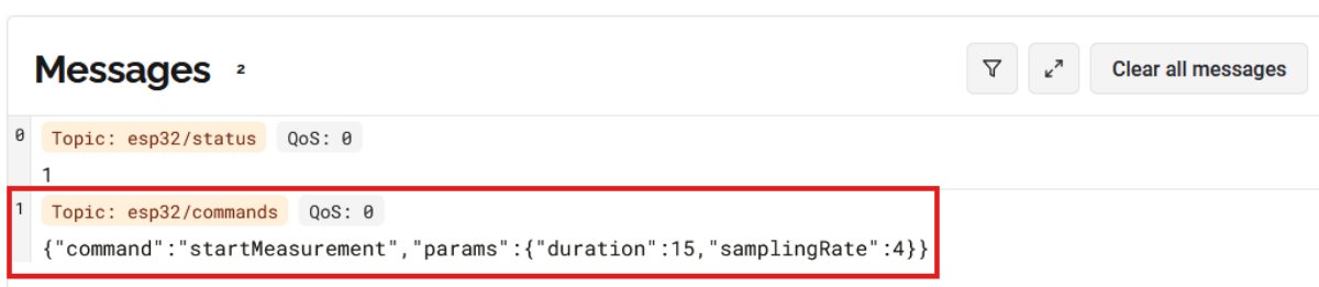
Figura 22 - Recebimento da solicitação da medição no broker MQTT.
