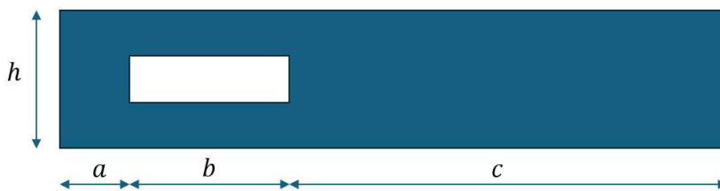
Figura 69: Parâmetros geométricos associados à posição e à dimensão da abertura Fonte: Autoria própria (2025).
