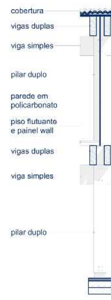
D.01 | elevação lateral pilar duplo 1:50
