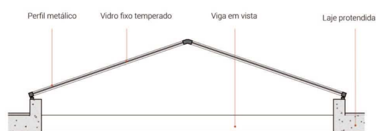
Detalhamento zenital Escala 1:25
