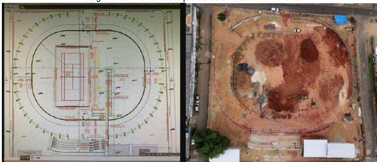
Fotografia 05: Planta e locação de obra velódromo manaus
