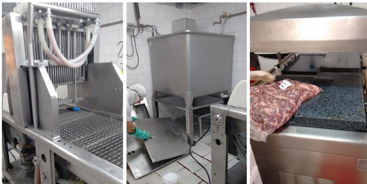
Figura 10 – Equipamentos utilizados na indústria (Campo 01) Em ordem: máquina que introduz temperos na carne; Câmara de temperos; e embaladora a vácuo.
