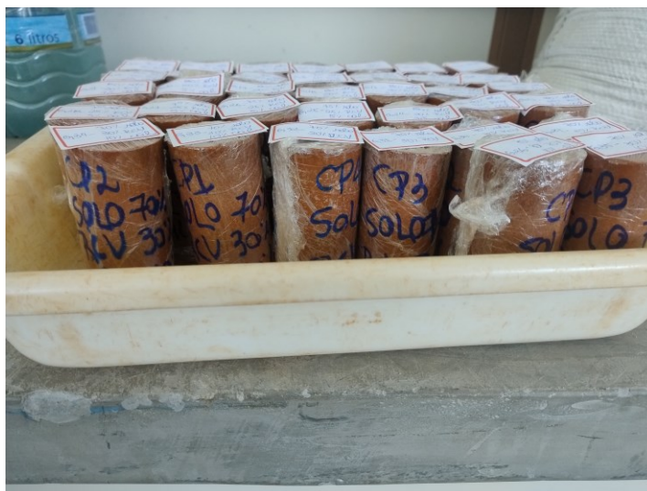
Fotografia 2 - Corpos de prova embalados e identificados, na câmara úmida
