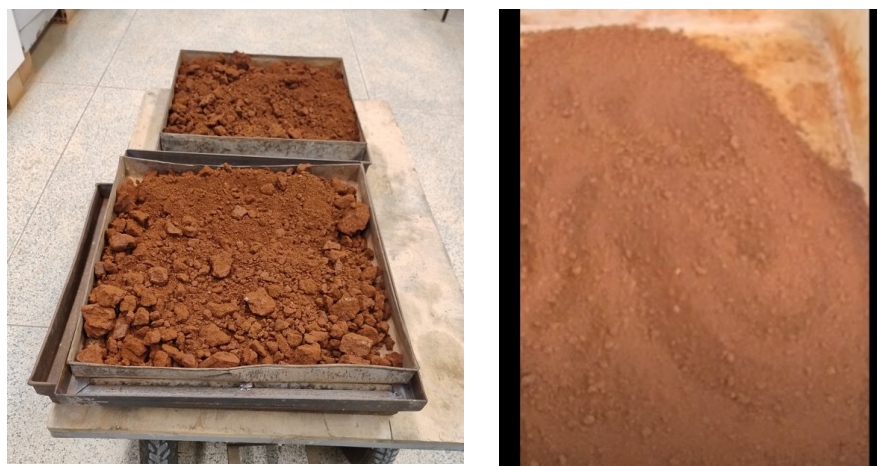
Fotografia 1 - Solo antes e após o processo de secagem e peneiramento
