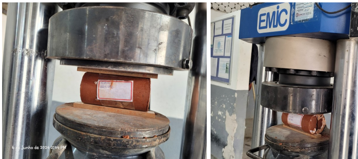
Fotografia 3 - Testes de resistência à tração e corpos de prova após ruptura
