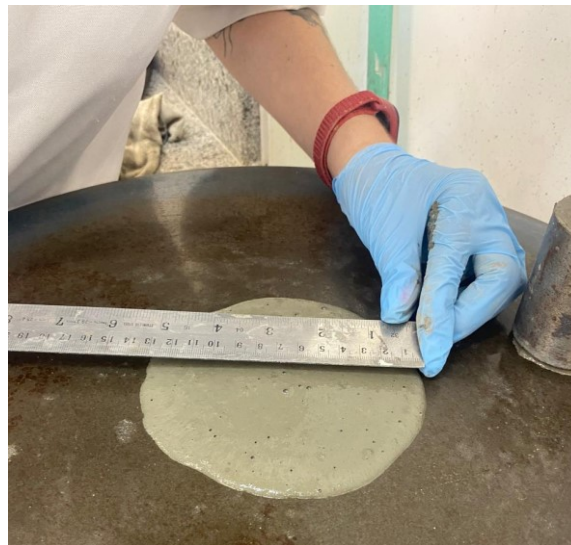
Figura 7 – Aferição do índice de consistência
