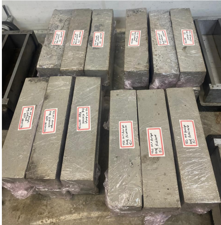
Figura 9 – Corpos de prova desmoldados
