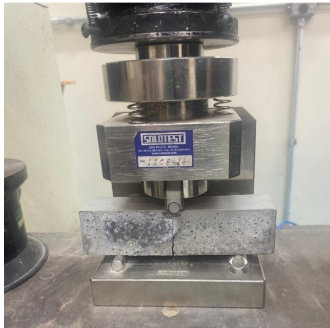
Figura 10 – Ensaio de resistência à tração na flexão
