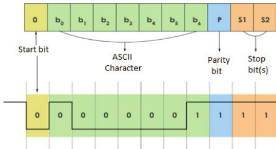
Figura 6 – Frame do protocolo RS232
