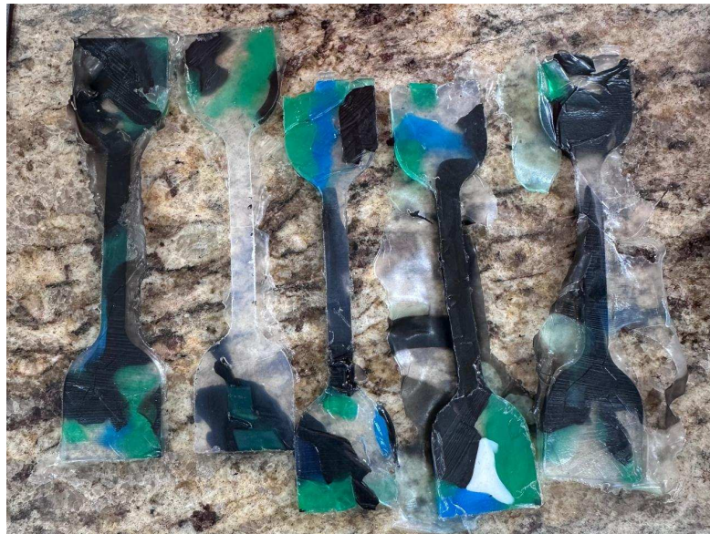
Figura 10 - Corpos de prova de EVA obtidos no final do processo com EVAs de cores distintas
