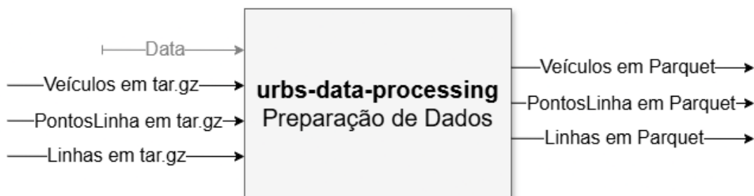
Figura 4 – Parâmetros de entrada e saída para a aplicação “ urbs-data-processing ” desenvolvida em (PEIXOTO et al. , 2020)
