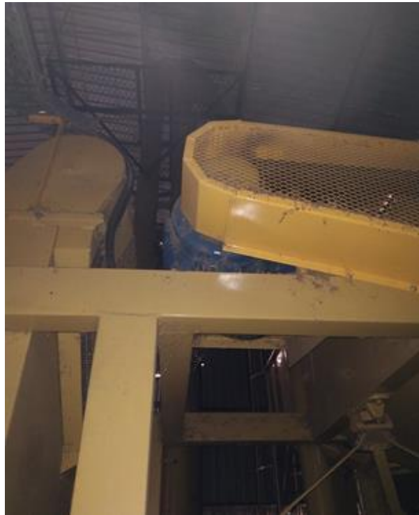
Figura 36 – Motor acionando por mecanismo por correias.
