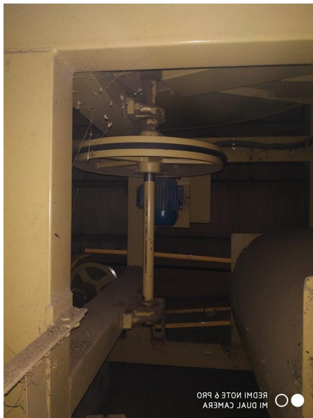
Figura 37 – Sistema de correias e motor, cesto de secagem.
