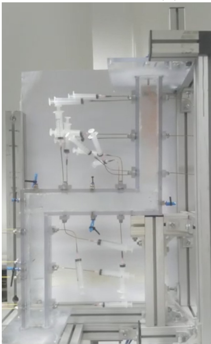
Figura 11 - Injeção de MEG com anilina em um instante de tempo para melhor visualização
