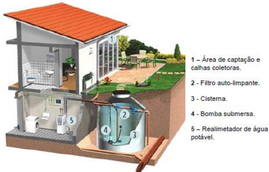
Figura 3 – Uma maneira de captação pluvial na Alemanha
